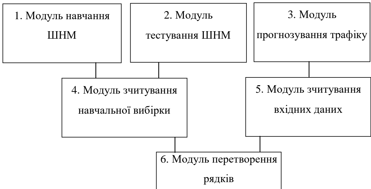
Рис. 2.1. Діаграма модулів системи для прогнозування автомобільного трафіку за допомогою ШНМ
