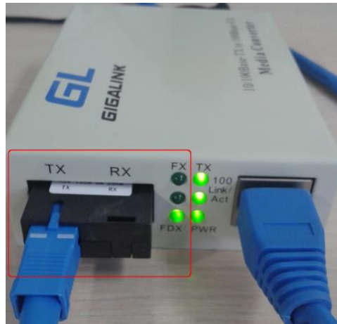
Рис. 3.20. Стан медіаконвертера (Немає сигналу по оптоволокну)
