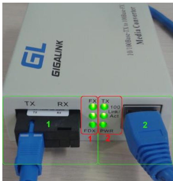
Рис. 3.19. Індикація в медіаконверторі
